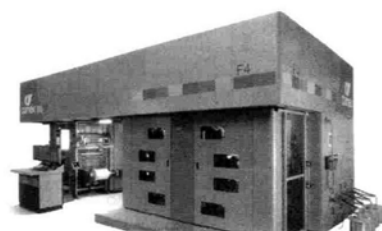
写真3 COMEXI社 F4 CI型印刷機 (印刷幅670mm)
