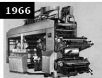
Comexi最初のセントラルインプレッション型フレキソ印刷機
